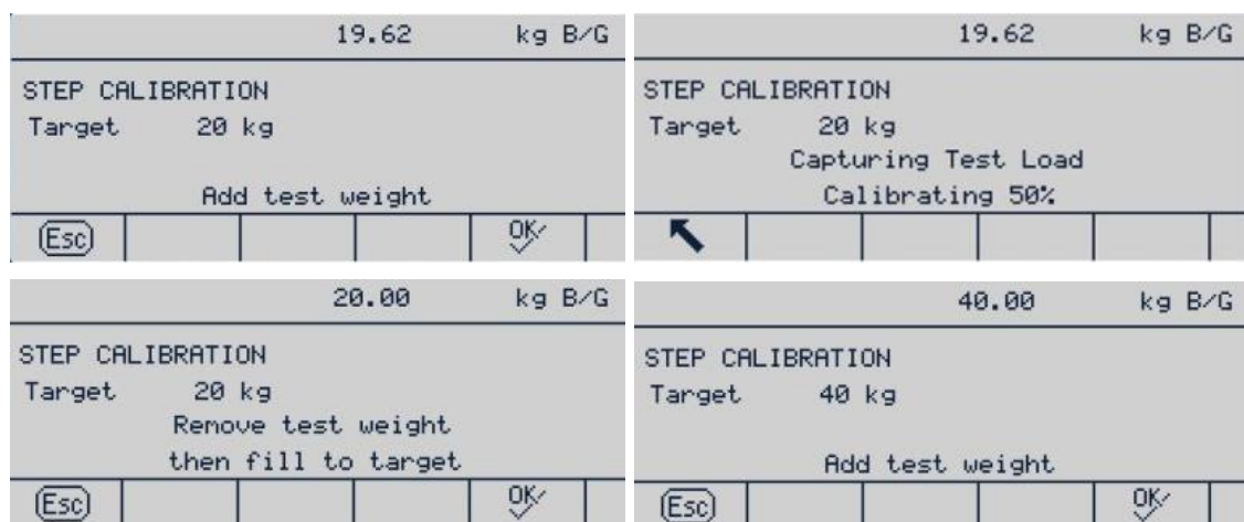
Figura 3-23: Taratura per fasi in corso
